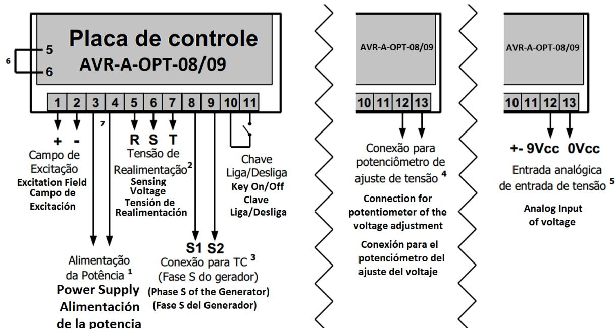
1- A conexão deverá ser feita respeitando-se a tensão especificada para o modelo. Ver tensão de alimentação na etiqueta de identificação do produto ou, em caso de dúvida, consultar o serviço de assistência técnica;
